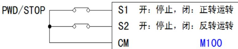
二线式运转控制（模式二）：限定参数P38，设定 01，限定端子S1、S2
