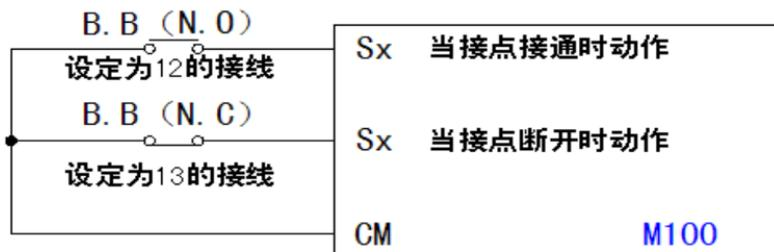
动作说明：当此设定功能端子的开关动作时，变频器的输出会立即切断，电机处于自由运转中。当开关状态复原时，变频器会以当时B.B.中断前的频率由上往下追踪到同步转速，再加速至设定频率。即使B.B.后电机已完全静止，只要开关状态复原就会运行速度追踪。
