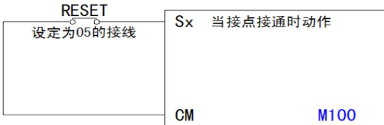
动作说明：当变频器发生异常现象，如**E.F.**、**O.H.**、**O.C.**、**O.V**等故障时，待故障原因排除后可藉此端子予与重置变频器，与数字键盘上的 **RESET** 键有相同的功能。
