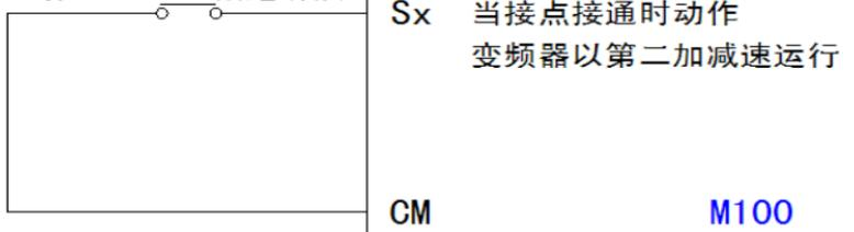
动作说明：当设定此功能端子的开关未闭合前，变频器的加减速是以参数P10、P11所设定的加减速时间来运行。当开关闭合时，变频器的加减速是以参数P12、P13所设定的加减速时间来运行。变频器若在恒速运行时，改变开关的状态对输出的频率并无变化，它真正的功能是发挥在变频器正在运行加减速时的状态。
