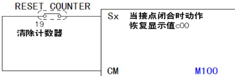
动作说明：当此功能端子动作时会清除目前计数的显示值，恢复显示“c00”，直到此信号消失，变频器才可接受触发信号向上计数。
