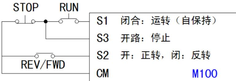
当参数P38 设定为 02 时除需按上图实施配线外，参数P39 所设定的任何功能立即失效，因已搭配三线式运转当成自保接点了。当参数P38 设定不为 02 时，参数P39 原有设定功能恢复。
