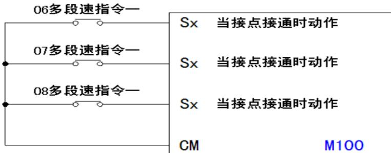
动作说明：利用此三个端子的开关组合共可组合成七段速度，若配合主速及点动可达成九段速之功能。相关配合的参数有**P17**、**P18**、
